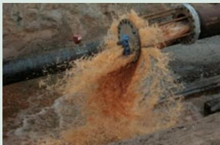
Les épreuves hydrauliques peuvent se retrouver dans différents domaines industriels. Lors de certification de pipeline de gaz ou lors d'arrêt de re-certification d'équipements : sphères de stockage, de ballons ou d'échangeurs tubulaires en raffinerie ou en pétrochimie. Il permet d'éviter les phénomènes de condensation dans les détendeurs ou de protéger les catalyseurs de la présence d'eau.
