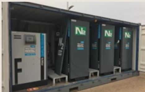
L'inertage des canalisations a pour but d'éviter tout risque de corrosion ou d'inflammation en cas de présence de carburant.
